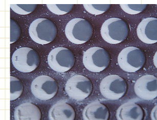
従来の丸型パンチングプレートによる灰の付着状況(実験)
