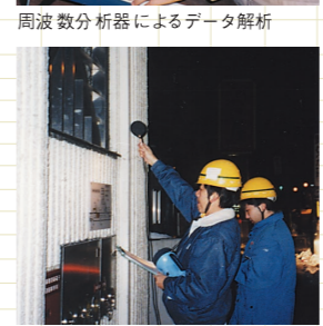
消音装置設置後(40dB以下)の受音点における騒音測定
