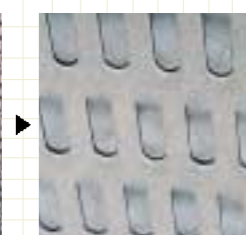
長穴パンチングプレート使用後の状況
