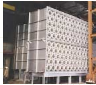
東北電力秋田火力発電所・押込送風機のサイレンサ
