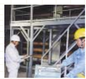
集塵機前の騒音測定
